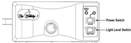
Para el Wallaby 3 (la foto de arriba), pulse el botón de la corriente (Power Switch) “On” y el nivel de luz (Light Level) a 2.
